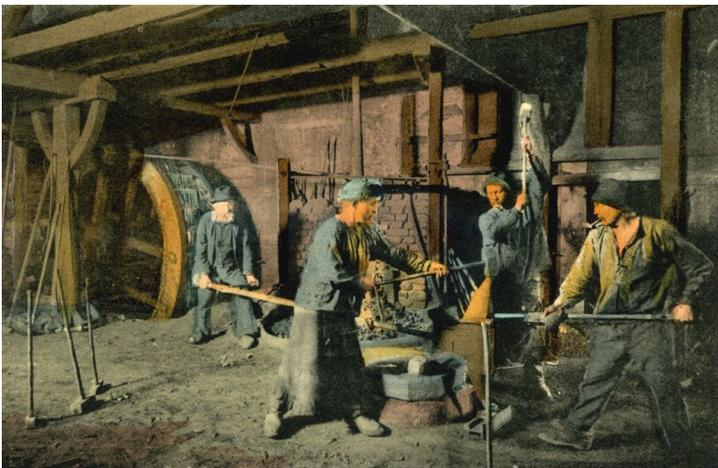
Abb. 1: Für das Zusammenschweißen der einzelnen Komponenten im Viertakt waren vier Schmiedegesellen zuständig. Die zu verbindenden Eisenstücke wurden im Feuer bis zur Weißglut erwärmt und aneinander gelegt. Mit gezielten Schlägen ihrer großen Handhämmer schweißten die Gesellen die Amboßteile zusammen. Immer einer nach dem Anderen – im Viertakt.
