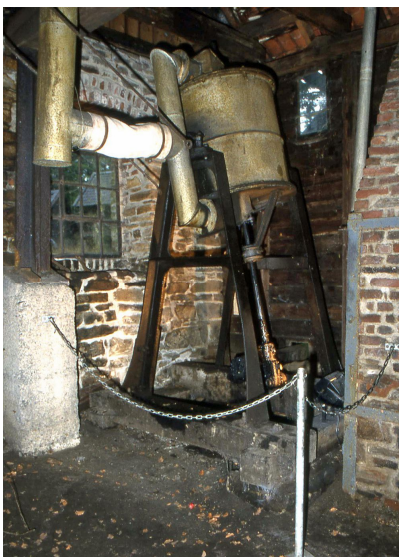
Abb. 14: Dieses „Cylindergebläse“ steht im Oelchenhammer bei Engelskirchen. Es funktioniert ähnlich wie eine Fahrradluftpumpe.
