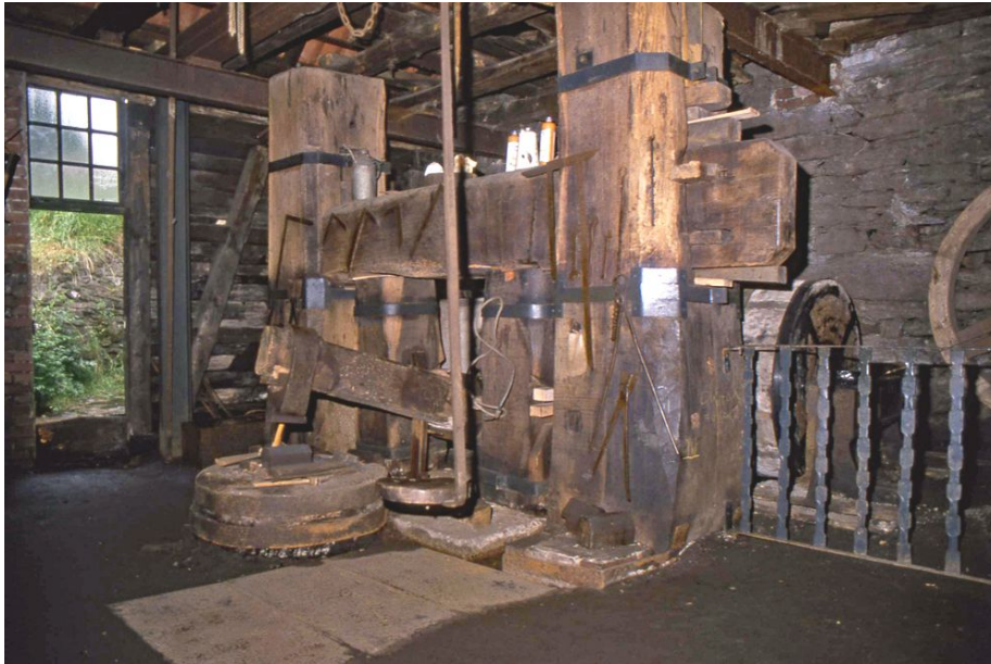
Abb. 7 : Im Steffenshammer zwischen Remscheid und Wuppertal. In dieser Außenstelle des Remscheider Werkzeugmuseums hat sich die älteste Bauart des Wasserhammers → das Viergespann bis heute erhalten
