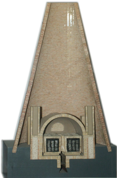
Abb. 13: Modell eines Zementationsofens im Deutschen Museum
